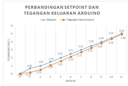
Gambar 5: Grafik perbandingan antara nilai set point pada HMI dengan remote I/O (Arduino Uno).
