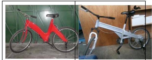
**Gambar 2 Rangka sepeda yang pernah dibuat**
