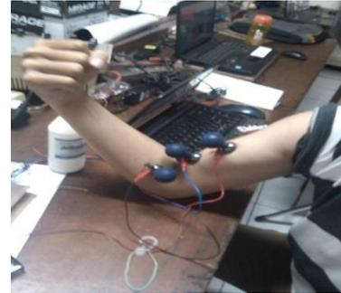
**Gambar 7 : Letak elektroda EMG pengukuran permukaan kulit di tangan**
