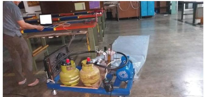
Gambar 6 Instalasi sistem kompresi biogas
