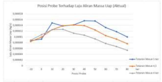
Gambar 7 Grafik posisi probe terhadap laju aliran massa uap (aktual)
