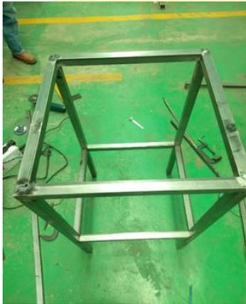
Gambar 10 Pembuatan Rangka
