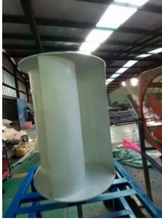
Gambar 9 Pembuatan Sudu Turbin
