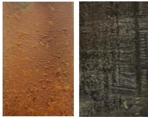
**Gambar 4.** Spesimen Baja Tanpa dan Dengan Inhibitor
