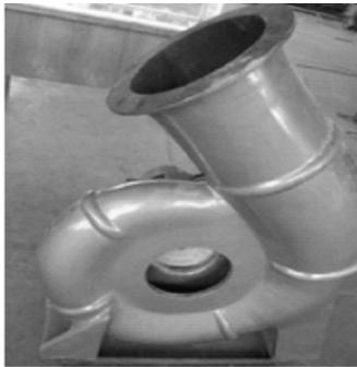
Gambar 1 *Prototype* komponen rumah turbin (hasil penelitian)
