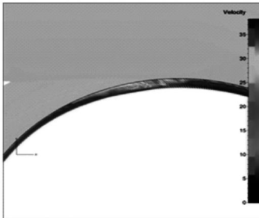
Gambar 9 Distribusi kecepatan absolute pada outlet casing spiral, simulasi kedua
