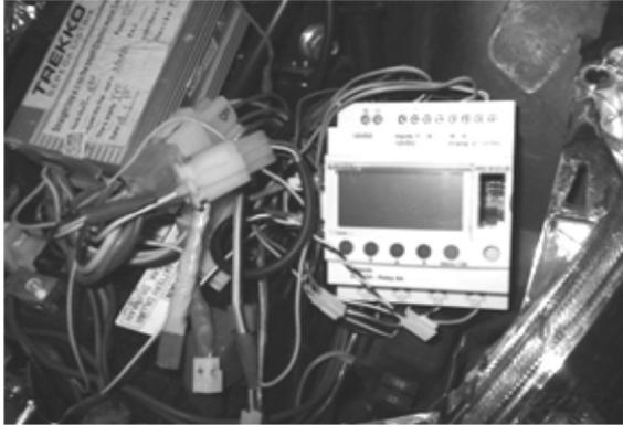
Gambar. 6 Penempatan PLC
