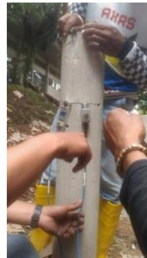
Gambar 8. Tata Letak Pemasangan Akselerometer dan Transduser alat *Pile Driving Analyzer*
