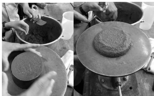
Gambar 1. Pengujian *Flow* Mortar Campuran Uji
