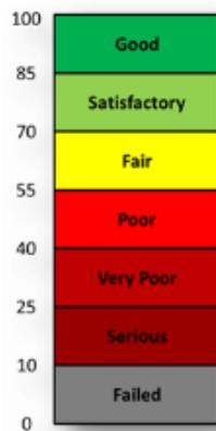
Gambar 2 Skala Indeks Kondisi Perkerasan Berdasarkan Nilai PCI
