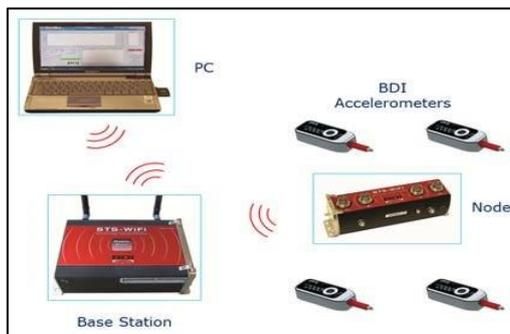
Gambar 3. Sensor *accelerometer* dan perangkat pengujian dinamik Bridge Diagnostic Inc. [4]
