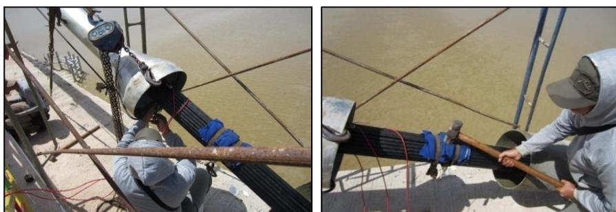
Gambar 4. Pemasangan sensor *accelerometer* dan eksitasi getaran dengan *hammer* [Dok. Pribadi]
