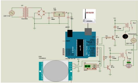
Gambar 3. Rangkaian Rancangan Sistem Kontrol Ruangan
