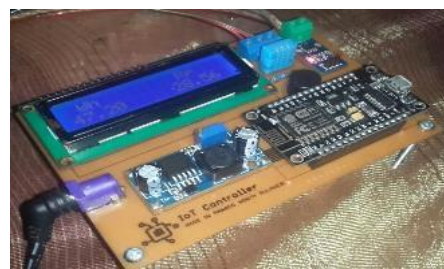
Gambar 5. Sistem monitoring konsumsi energi listrik peralatan penyejuk udara berbasis IoT
