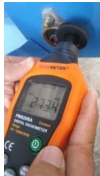
Gambar 4. Pengujian RPM motor pelontar
