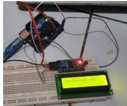
Gambar 4.7 Realisasi Rangkaian Pengujian I2C
