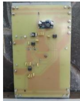
Gambar 8. Modul frequency to voltage yang digunakan
