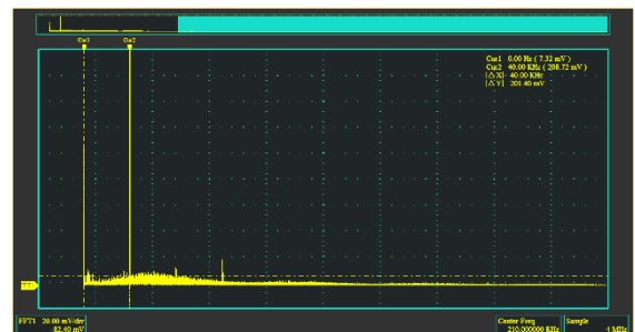
Gambar 12. Pengukuran Respon Frekuensi Menggunakan Spectrum Analyzer Dengan Catu Daya Adaptor 5V
