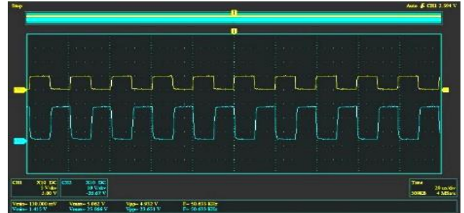
Gambar 6. Pengukuran Frekuensi 50 KHz Pada Switching LED
