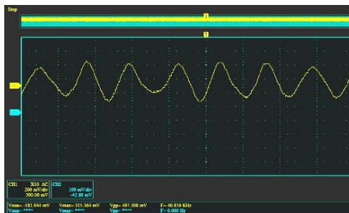
Gambar 9. Pengukuran Sinyal Saat Keadaan Tidak LOS ( Line of Sight )
