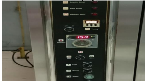
Gambar 5 Monitor Mesin Oven Rotary Tipe NFX-320 yang Menunjukkan Temperatur dalam Ruang Pengeringan Oven
