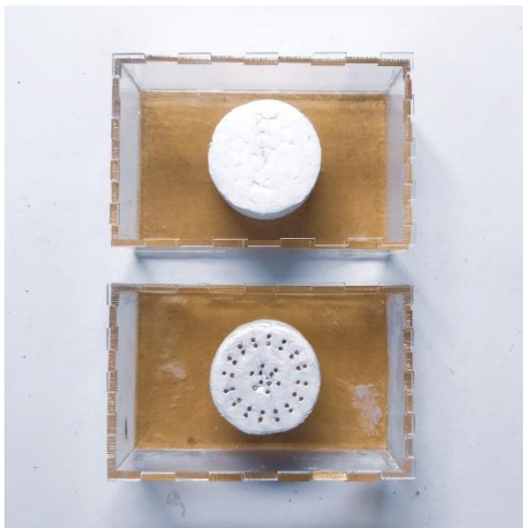
Gambar 3. Material dielektrik konvensional dan artifisial
