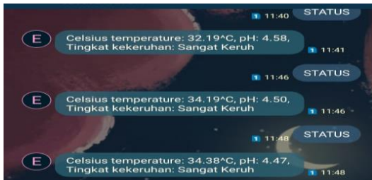
Gambar 5 Contoh Hasil Pembacaan Suhu, pH, dan Kekeruhan Menggunakan Jaringan GSM
