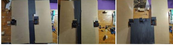
Gambar 13. Arah Gerakan Papan Pelipat oleh Motor Servo 1, 2, dan 3
