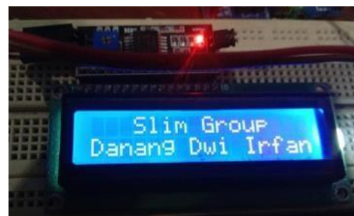
Gambar 6. Pengujian Display LCD 16 × 2
