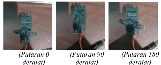
Gambar 7. Pengujian Motor Servo
