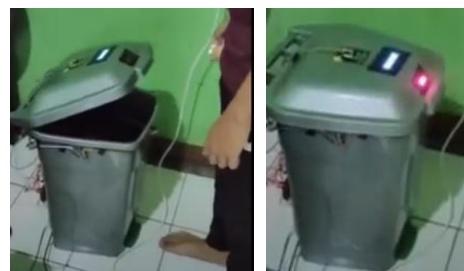
Gambar 9. Hasil Pengujian Sistem Tutup/Buka Kap Tempat sampah
