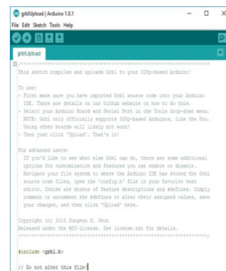
Gambar 9. Realisasi Program untuk Mengupload Grbl pada Arduino
