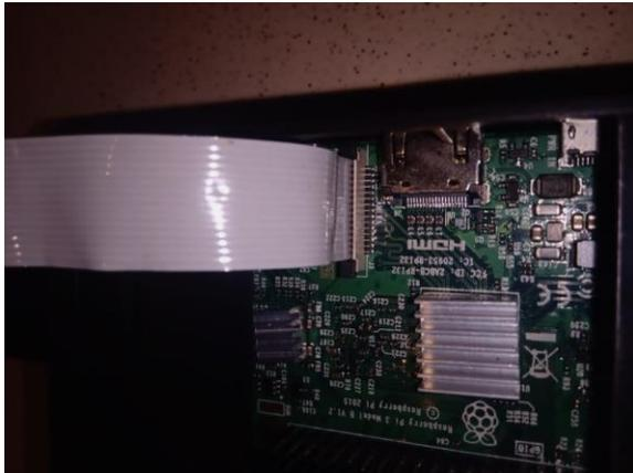
Gambar 7. Instalasi Modul Kamera
