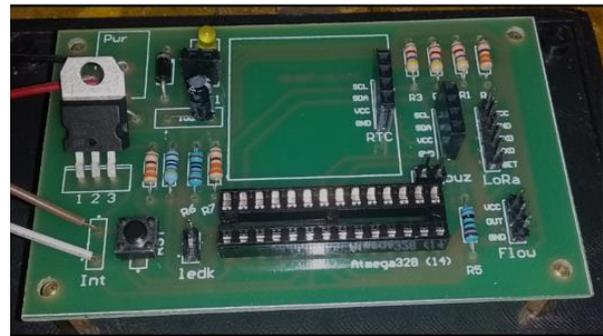
Gambar 7 Rangkaian sensor node
