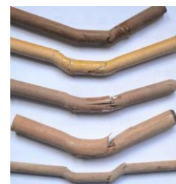
Gambar 9. Tipe kerusakan pasak kayu ulin berdasarkan penelitian sebelumnya Sumber: Palaeowati, 2013
