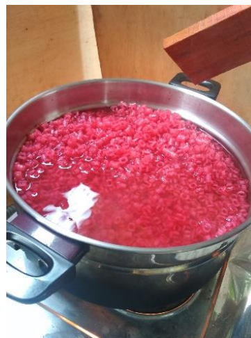
Gambar 4. Proses pewarnaan bushing secara manual.
