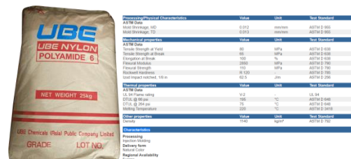
Gambar 2. Material UBE NYLON dan Karakteristiknya [3]
