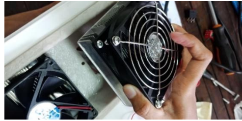
Gambar 5. Pemasangan Komponen Sistem Pendingin pada Cooling Box
