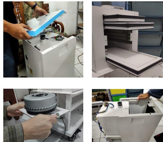
Gambar 2. Pembongkaran dan pengukuran produk existing
