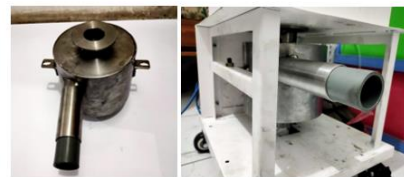
Gambar 6. Pembuatan dan pemasangan cyclone separator
