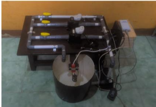
Gambar 4. Sistem Meter Air M-Bus
