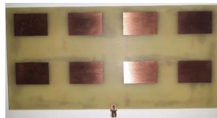
Gambar 11. Antena Mikrostrip Array 2x4 dengan Teknik Pencatutan Proximity Coupled Hasil Fabrikasi
