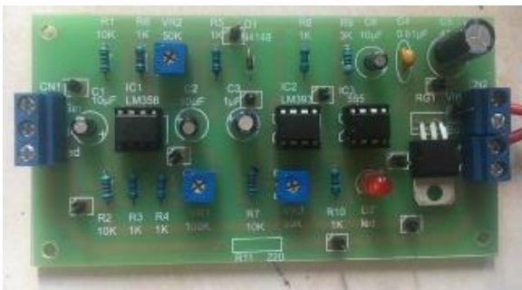
Gambar 11. Hasil Perakitan Komponen di Atas PCB
