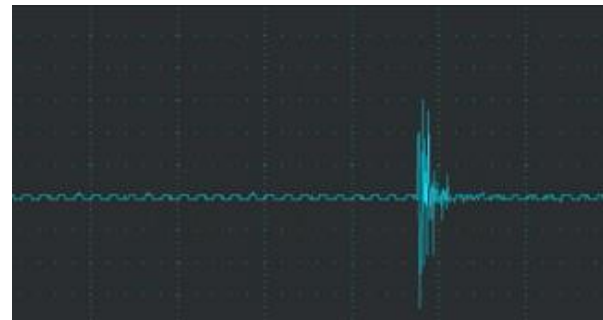
Gambar 5. Tampilan pada Layar Osiloskop Saat Piezo Mendeteksi Pantulan Bola
