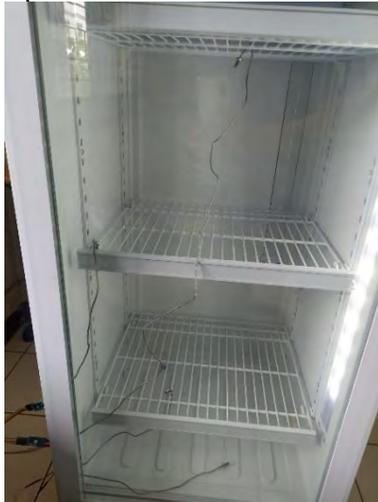
Gambar 8 Penempatan Sensor
