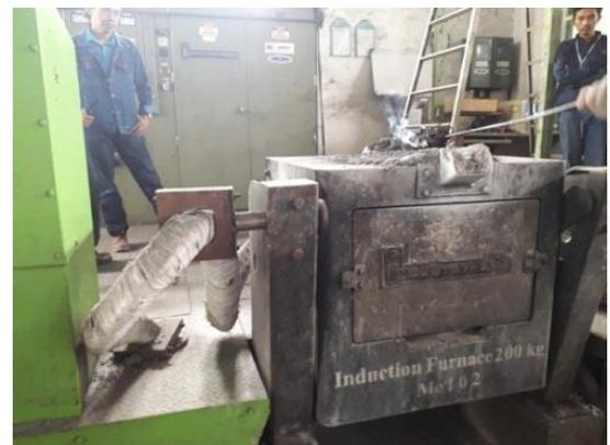
Gambar 4 Tungku induksi (*Induction Furnace*)
