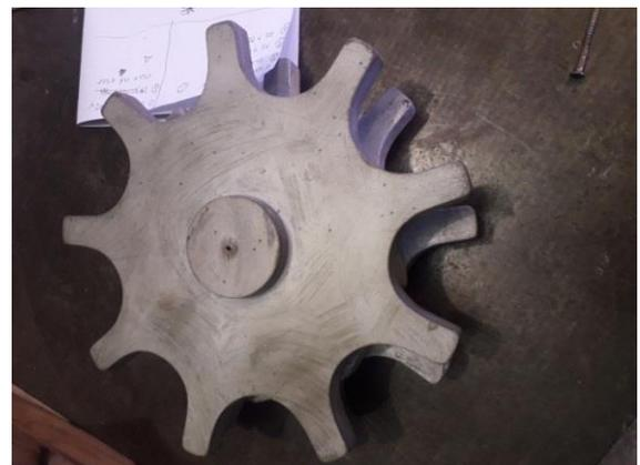
Gambar 2 Pola kayu *sprocket*
