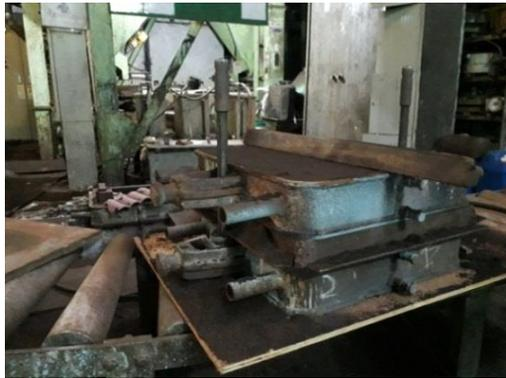
Gambar 3 Cetakan pasir kering
