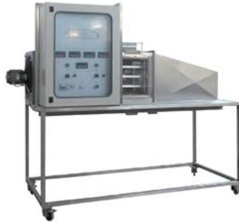
Gambar 1. Rangkaian alat *tray dryer*
