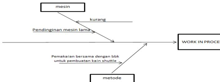
Gambar 5. Fishbone Diagram Penyebab WIP Pada Stasiun Kerja Vacuum Heat Setter
