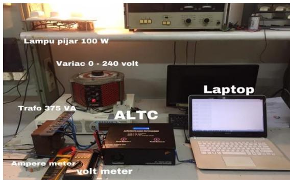
Gambar 10. Pengujian Sistem ALTC
