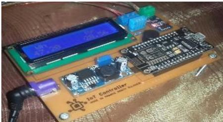
Gambar 6. Sistem pengontrolan kerja peralatan penyejuk udara berbasis *IoT*
