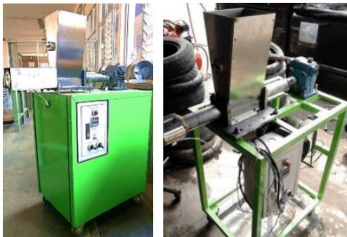
Gambar 1. Alat pengolah sampah EPS dengan metode ekstrusi berkapasitas 5 kg/jam [5]
