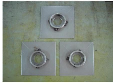
Gambar 9. Hasil pembuatan bearing yang digunakan
