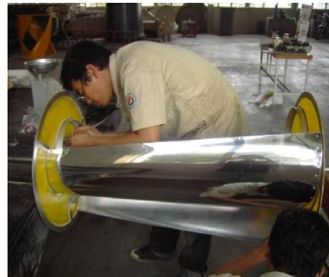
Gambar 9. Hasil pembuatan flange yang digunakan sebagai penguat bilah rotor
