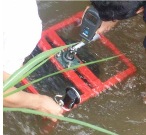
Gambar 8. Proses menghitung kecepatan sudut dengan tachometer
