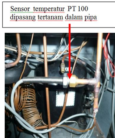
Gambar 7 Posisi sensor temperatur pada mesin uji.
