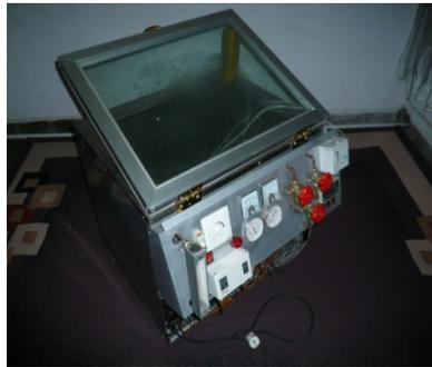
Gambar 6 Mesin refrigerasi dengan *secondary refrigerant* hasil perakitan
