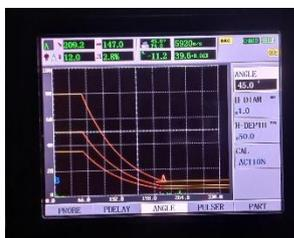
Gambar 4.6 Kurva DAC Probe Sudut 45°
