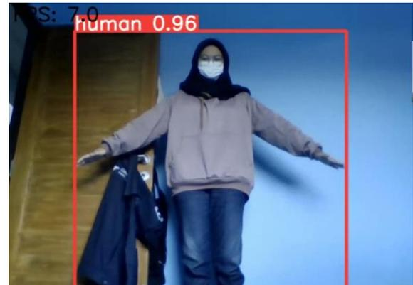
Gambar 4 Hasil pendeteksian manusia menggunakan kamera *webcam*.
