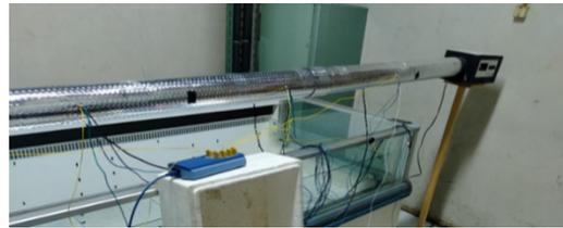
Gambar 2.a. Simulator Cerobong Tata Udara
