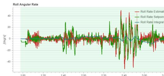
Gambar 14. Grafik roll angular rate dengan nilai  $K_i=0.1$
