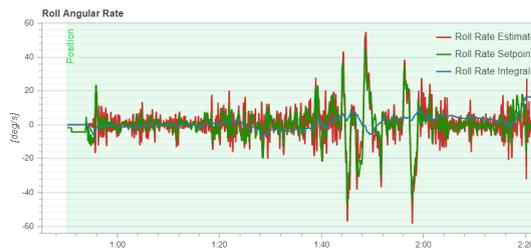
Gambar 12. Grafik roll angular rate dengan nilai  $K_i=0.4$
