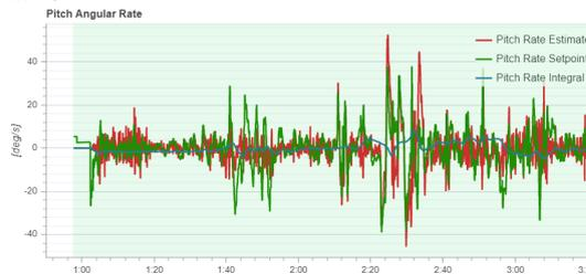
Gambar 15. Grafik pitch angular rate dengan nilai  $K_i=0.1$
