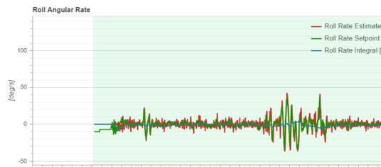
Gambar 20. Grafik roll angular rate dengan nilai  $K_p=0.23$   $K_i=0.6$  dan  $K_d=0.008$
