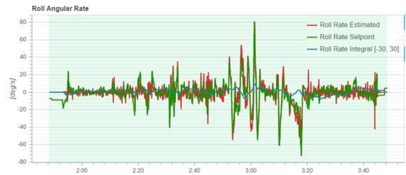
Gambar 16. Grafik roll angular rate dengan nilai  $K_d=0.005$
