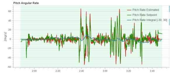
Gambar 17. Grafik pitch angular rate dengan nilai  $K_d=0.005$
