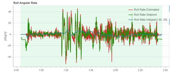
Gambar 18. Grafik roll angular rate dengan nilai  $K_d=0.002$
