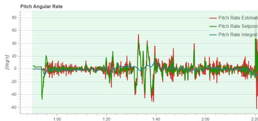
Gambar 13. Grafik pitch angular rate dengan nilai  $K_i=0.4$
