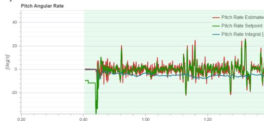
Gambar 21. Grafik pitch angular rate dengan nilai  $K_p=0.23$   $K_i=0.6$  dan  $K_d=0.008$
