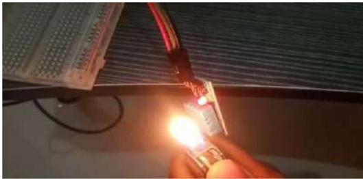
Gambar 6. Pengujian Kondisi Panas Sensor DHT11
