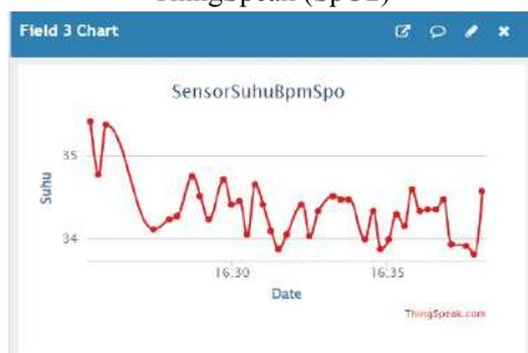
Gambar 10. Hasil monitoring pada web server ThingSpeak (Suhu)
